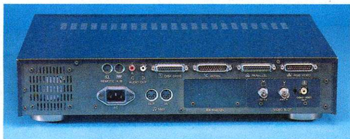
Anschlüsse: Es gibt u.a. eine parallele und serielle Schnittstelle sowie einen FBAS- und Y/C-Ausgang und MIDI-Buchsen
