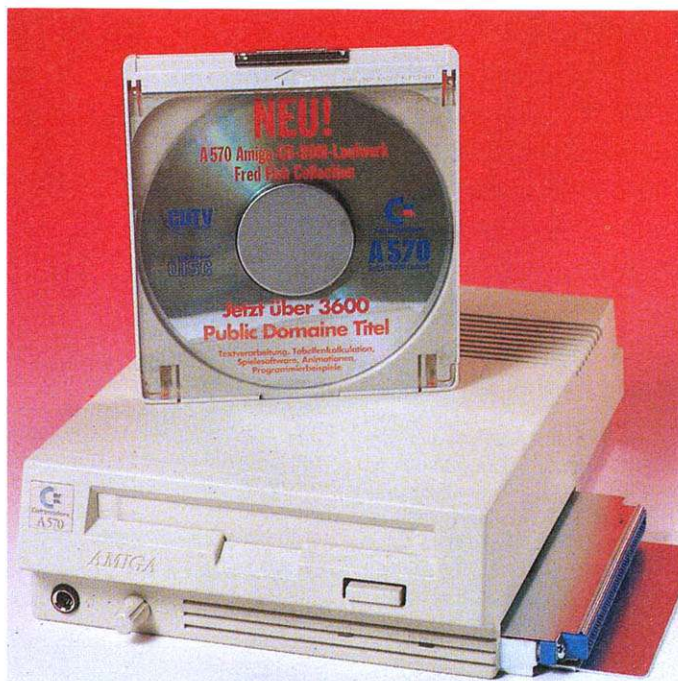
A 570: Mit dem externen CD-ROM-Laufwerk kann man mit dem Amiga 500 (Plus) CDTV-Software benutzen. Seite 144
