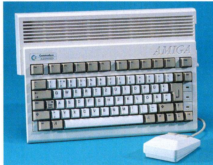
Der Kleinste: Flottes Design und beim Amiga 600 HD sogar noch eine interne 2 1/2-Zoll-Festplatte für Anspruchsvolle
