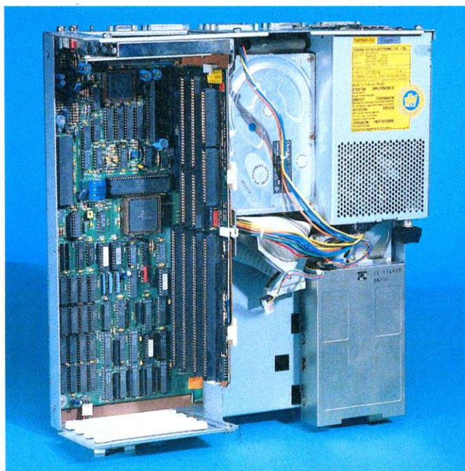
Interna: Der Amiga 3000 läßt sich auf der Mutterplatine auf maximal 2 MByte Chip- und 16 MByte Fast-RAM aufrüsten
