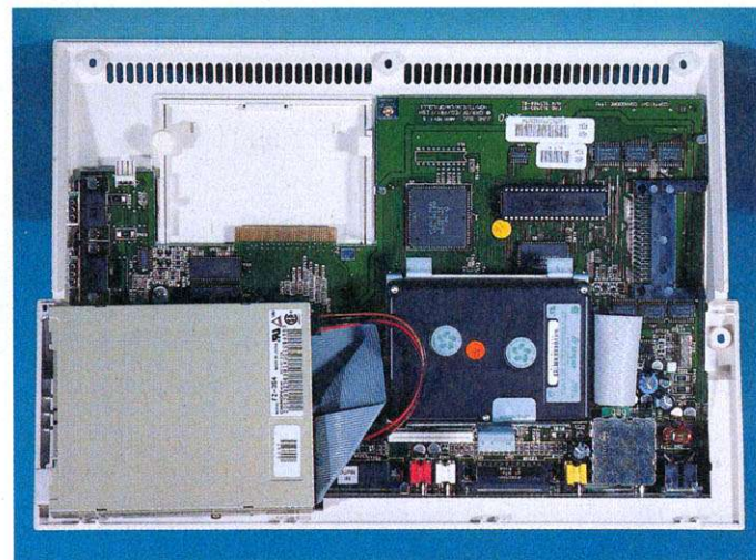
Interna: Kompaktheit durch Einsatz von SMD-Technik. Alle Bauteile der Platine bis auf das Kickstart-ROM sind verlötet.
